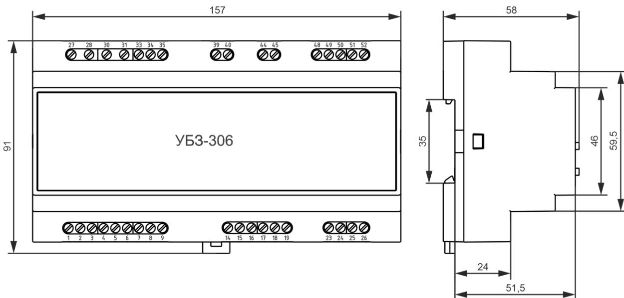
Рисунок 1.1 – Габаритные и установочные размеры УБЗ-306
