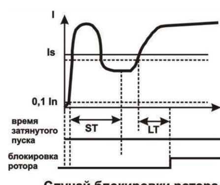
Рисунок 3.3 – Затянутый пуск и блокировка ротора
