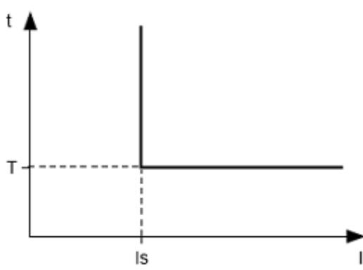
Пример. При “ $I_{max}$  коэф”=4, “ $I_{nom}$  двигателя”=10, “ $I_{max}$  времени”=10, двигатель выключится через 10 с, после того как один из фазных токов превысит 40 А.
