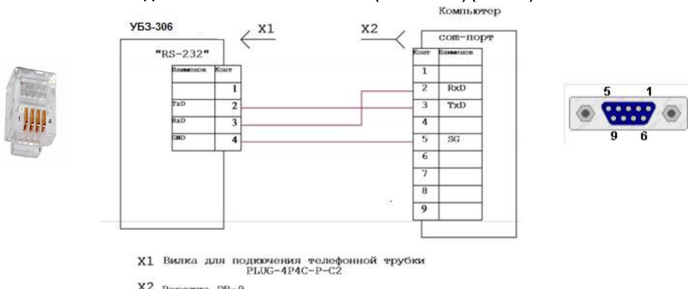
Рисунок 5.11 – Схема подключения УБЗ-306 к ПК
