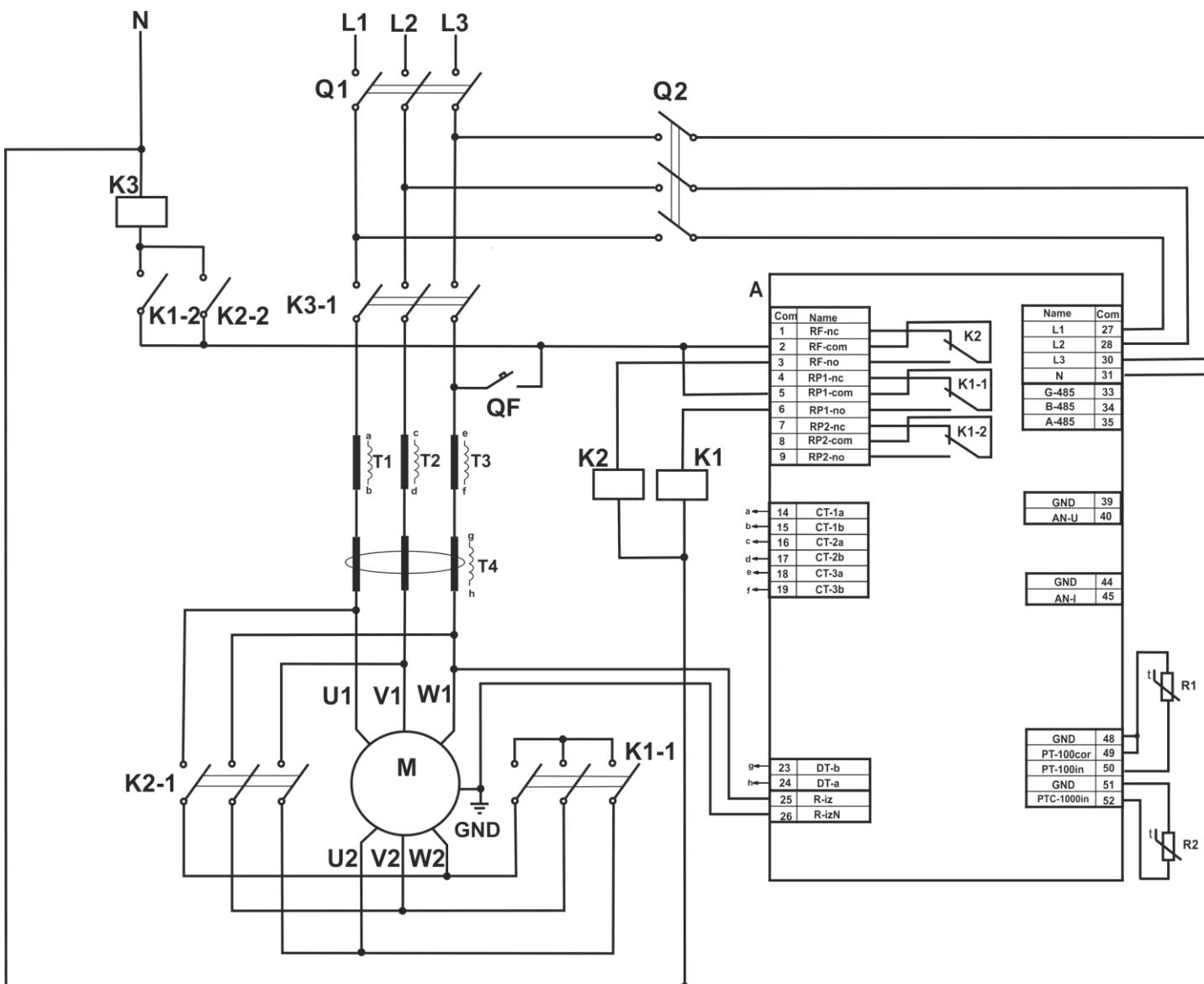
K1 – пускатель включения обмоток двигателя звездой;
