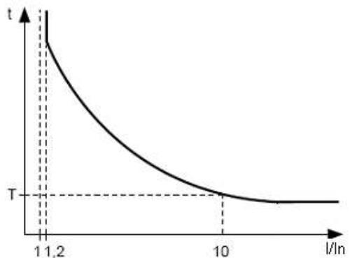
$I_n$  соответствует уставке “ $I_{nom}$  двигателя” (номинальный ток двигателя);
