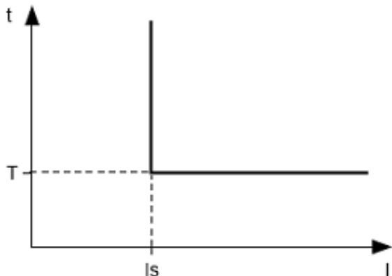
Рисунок 1.2 - Принцип защиты с независимой выдержкой времени
