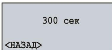
**Рисунок 7.8.8** – Экран настройки таймаута подключения к Web-серверу
