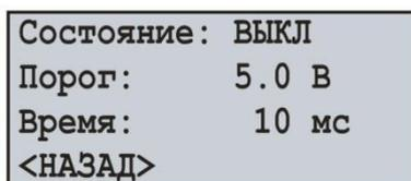
Рисунок 7.6.5 – Экран настройки верхнего или нижнего порогов события
