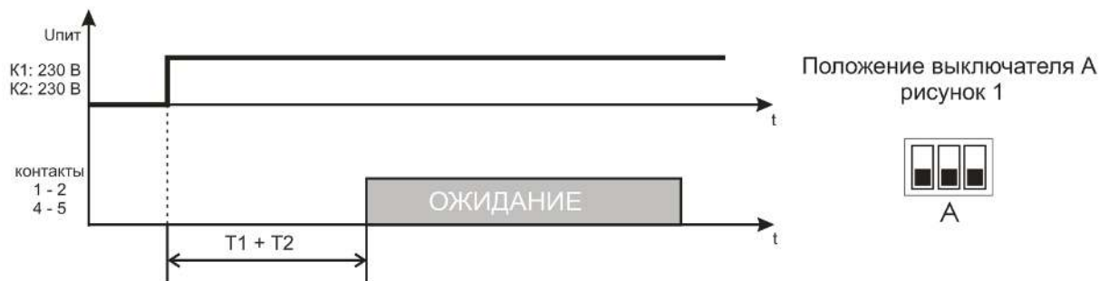
Рисунок 3 – Алгоритм работы Реле с задержкой на включение
