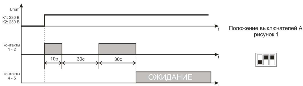
Рисунок 6 – Алгоритм работы Реле управления (предпусковая сигнализация)
