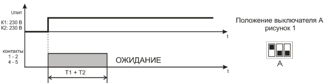
Рисунок 7 – Алгоритм работы Реле импульсное 2
