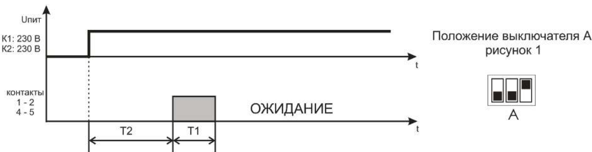
Рисунок 4 – Алгоритм работы Реле импульсное 1
