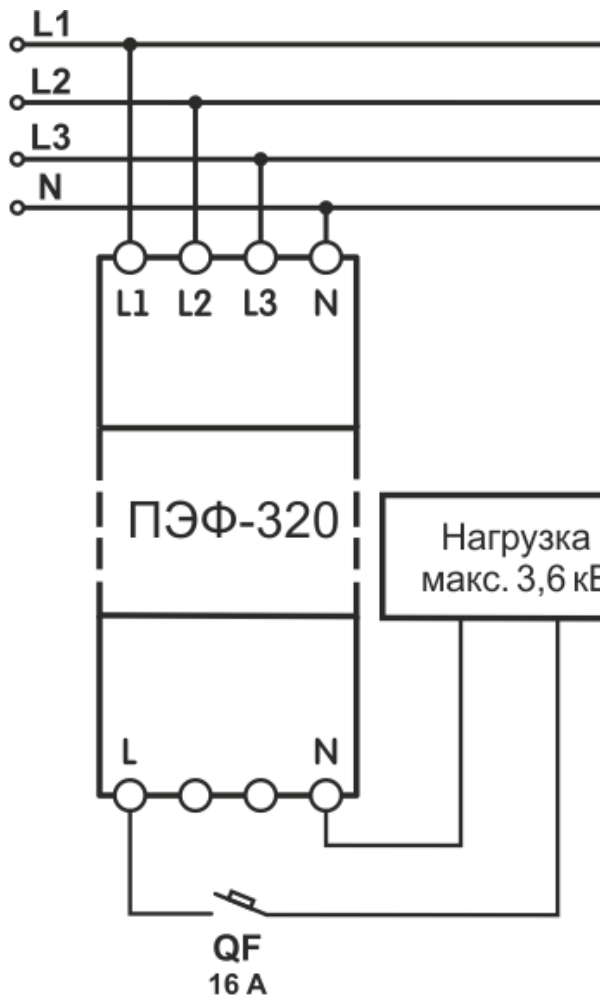
Рисунок 2 – Схема подключения ПЭФ-320
