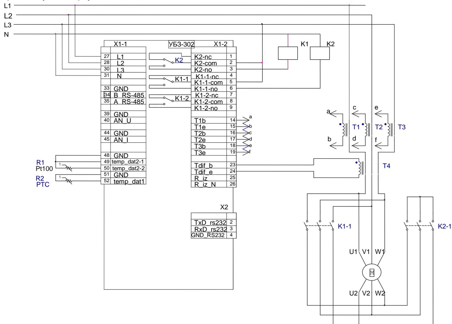
K1 – пускатель включения обмоток двигателя треугольником
