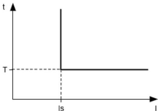
$I_s = "i^2S"$  (кратность срабатывания) \* " $I_{nd}$ " (номинальный ток двигателя), а  $T$  - время задержки срабатывания защиты
