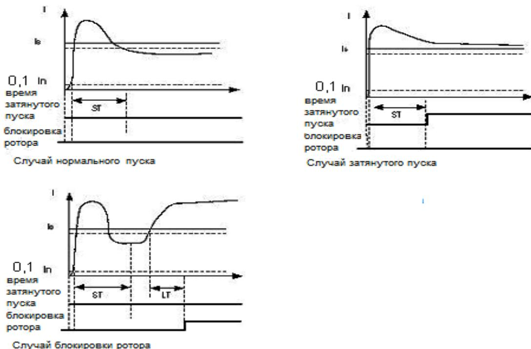
**Рисунок 1.4 - Затянутый пуск и блокировка ротора**
