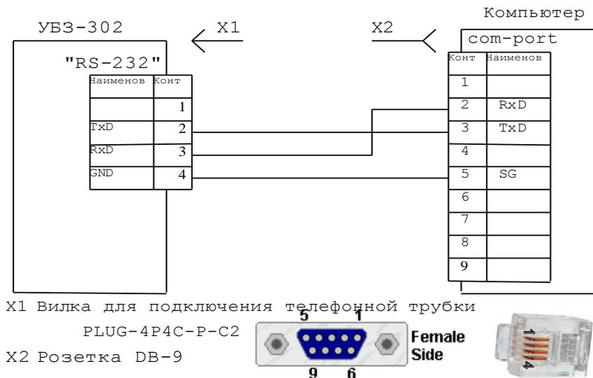
Рисунок 2.2 - Схема подключения УБЗ-302 к компьютеру
