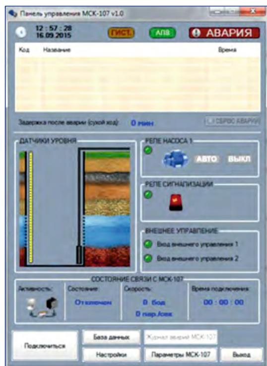
— Дискретные входы 1 и 2 используются для ручного управления электродвигателем насоса
