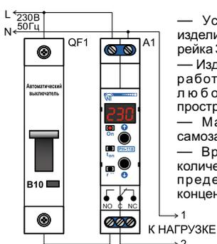
— Установка (монтаж) изделия - стандартная DIN-рейка 35 мм
